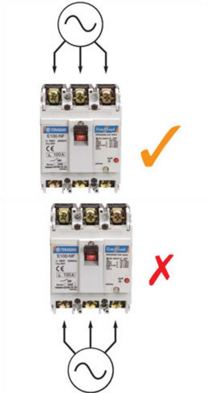
Автоматические выключатели мини МССВ серии TemBreak2 не поддерживают реверсивного направления подачи напряжения. Напряжение должно подаваться на верхние клеммы автоматического выключателя.
